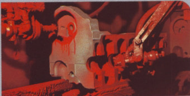
Innenlackierung des Motorblocks
