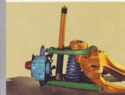
Einzelradführung und -federung
