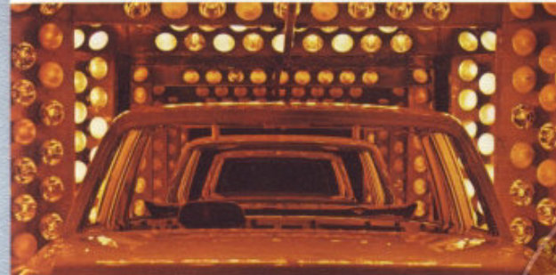
Einbrennen der Lackschichten zwischen 130° und 165° C
