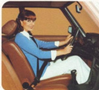
■ Die Sicherheitsgurte mit Aufroll-Automatik lassen volle Bewegungsfreiheit und werden erst fixiert, wenn das Gurtband plötzlich belastet oder der Wagen stark abgebremst wird.
