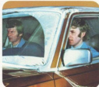
■ Durch ein neuentwickeltes Profil an den vorderen Dachsäulen bleiben die Seitenscheiben sauber, denn das Schmutzwasser wird abgeleitet.
