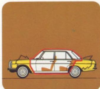
■ Das Knautschprinzip der Karosserie: gestaltfester Innenraum (Sicherheitszelle), aber verformbare Front- und Heckpartien, die Aufprallenergie vernichten.
