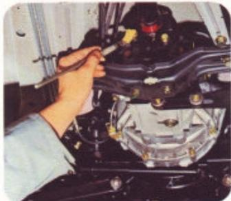
Wichtige Schrauben werden von Hand überprüft. Farbmarkierung bedeutet: Prüfung bestanden.
