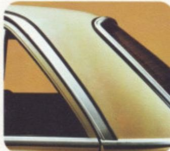
■ Der Innenraum wird zwangsweise entlüftet durch Schlitze in den hinteren, hochstabilen Dachsäulen. Eine Regenrinne über der Heckscheibe leitet das Wasser seitlich ab.
