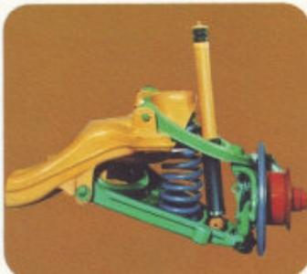
■ Einzelradführung und -federung: Vorn: Doppelquerlenker mit Bremsnick-Abstützung.
