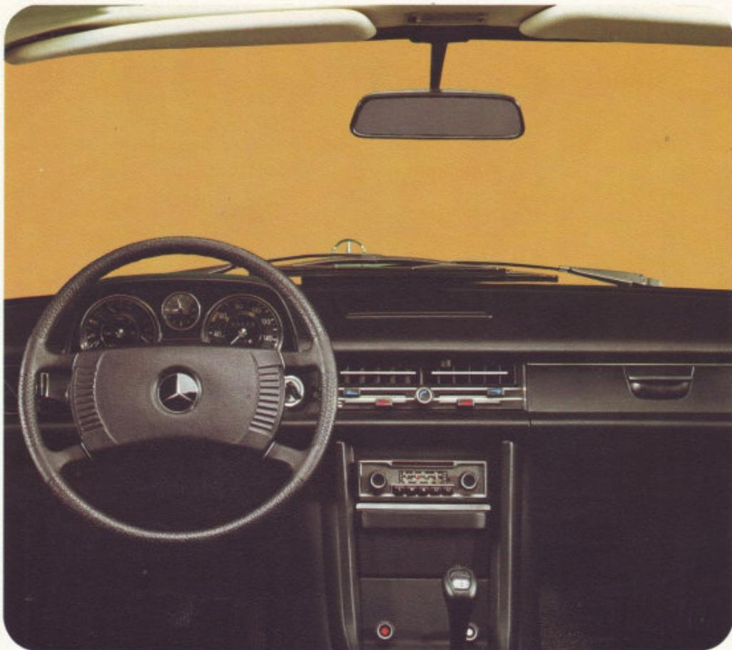
■ Die Mercedes-Benz Sicherheitsarmaturen-anlage wurde nach den Erkenntnissen ungezählter Unfallversuche konstruiert. Unter der Oberfläche ist Polyurethanschaum auf gezogenem Blech. Darunter sind Hohlräume, so daß die Armaturen-anlage je nach Heftigkeit des Aufpralls stufenweise, tiefgestaffelt nachgibt und Aufprallenergie vernichten kann.
