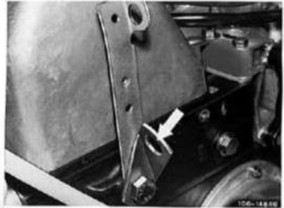
19 Motor mit dem Motordirigenten und einem Kran soweit wie möglich anheben. Dazu beim Typ 123 hintere Klammer am Luftfilter öffnen, damit sie beim Hochheben nicht an der Batterie anstößt.
