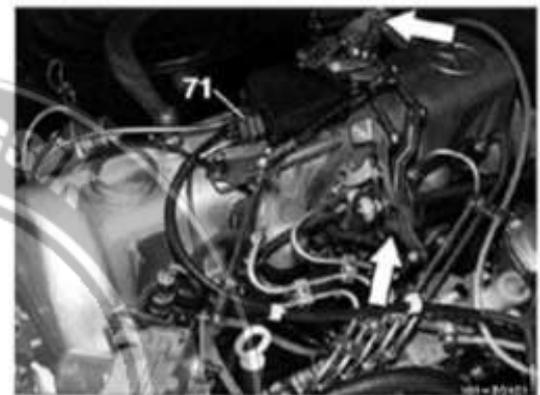
12 Motor auf OT des 1. Zylinders stellen. Dazu die Schraube M 18 x 1,5 x 45 mit Tellerscheiben in die Kurbelwelle schrauben.
