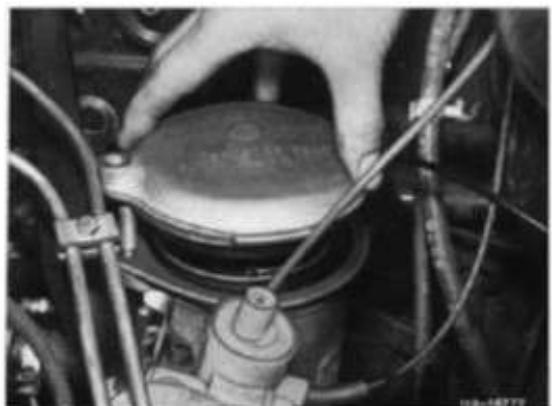
10 Beim Typ 116.120 Kältekompressor mit angeschlossenen Leitungen abbauen und zur Seite legen. Dazu die 3 Schrauben (6, 6 und 7) heraus-schrauben.
