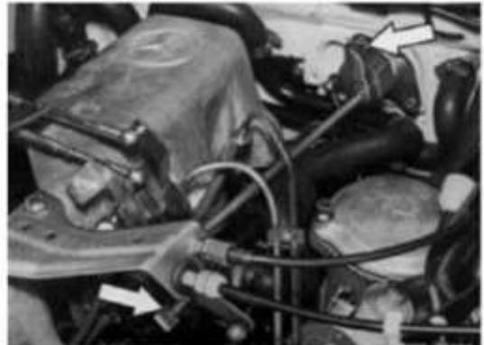
Bei den Typen 123 mit automatischem Getriebe 722.303 (W 4 A 040) und 126.120 Zentralstecker Unterdruckleitungen (71) bzw. Unterdruckleitungen abziehen. Bowdenzug aushängen, schwarzen Kunststoffclips (Pfeil) zusammendrücken und Bowdenzug nach hinten aus dem Halter herausziehen.
