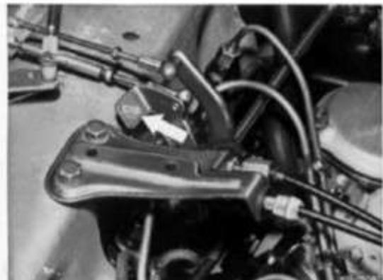
4 Einschraubstück in die Glühkerzenbohrung oder das Anschlußstück (Bestandteil des Verdichtungsdruckschreibers) in die Vorkammer schrauben.
