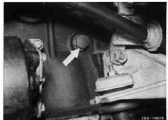
Ablaßschraube am Zylinderkurbelgehäuse
