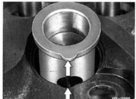
12 Gewinding (50) einölen und mit dem Zapfenschlüssel auf das vorgeschriebene Anziehdrehmoment 150–180 Nm anziehen.
