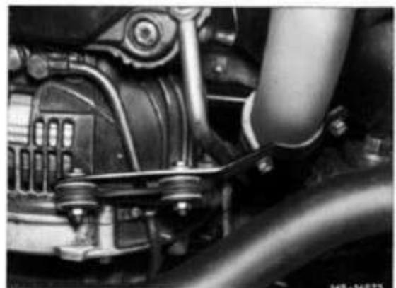
10 Ölmeßstabführungsrohr des automatischen Getriebes am Ladeluftrohr abschrauben.
