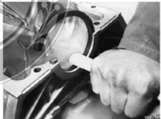
24 Um eine Überdeckung zu erreichen, den Radialdichtring 1 mm oberhalb der Trennfläche abschneiden. Hierzu selbstangefertigte Lehre verwenden.
