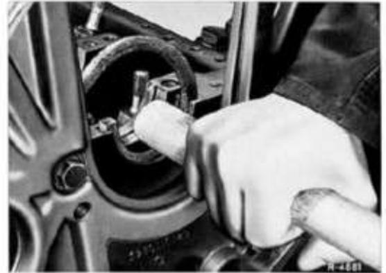
4 Um die erforderliche Überdeckung zu erreichen Radialdichtring im Zylinderkurbelgehäuse und Ölwanne ca. 1,0 mm oberhalb der Trennfläche abschneiden.
