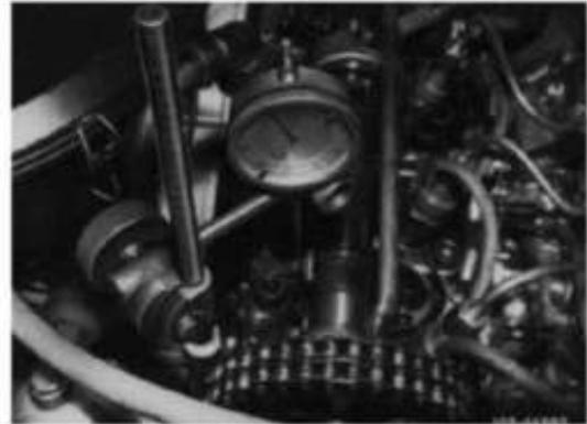
6 Meßuhr einsetzen und so befestigen, daß der Taststift unter einer Vorspannung von 3 mm (kleiner Zeiger der Meßuhr) auf dem Ventilderteller aufsitzt (Pfeil).
