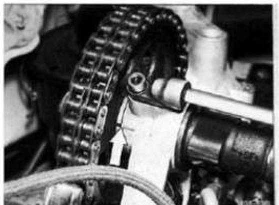
43 Gleitschiene einbauen.
