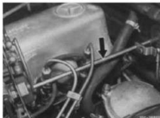
Bei den Typen 116.120 und 123 Längsregulierwelle nach vorne aus dem Gummilager herausziehen und nach hinten herausnehmen.
