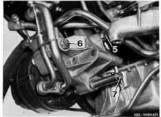
Bei den Typen 123 und 126.120 Klimaanlage entleeren und die Leitungen (Pfeile) abschrauben.
