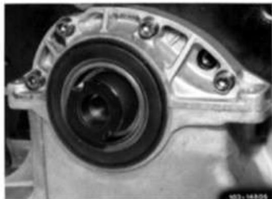
5 Befestigungsschraube (56) des Ölpumpen-Kettenrades herauschrauben (Bild Ziffer 9).
