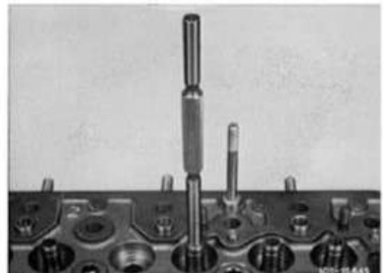
2 Ventilsitz ( $30^\circ$ ) bearbeiten (siehe Bedienungsanleitung des Werkzeugherstellers).
