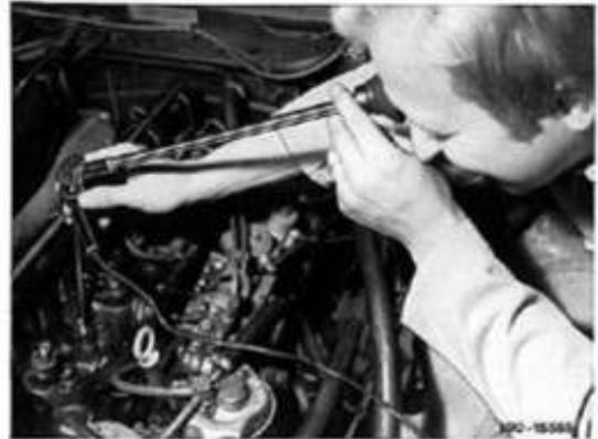
Zunächst ist bei Markierungen auf den Zylinderlaufbahnen zwischen „optischen Streifen“ oder „Freß-Streifen“ zu unterscheiden. „Optische Streifen“ sind meistens bis zu 3 mm breite Streifen, die vom Ringstoß herrühren, bei denen aber Honspuren noch sichtbar sind; bei „Freß-Streifen“ dagegen sind die Honspuren nicht mehr sichtbar.
