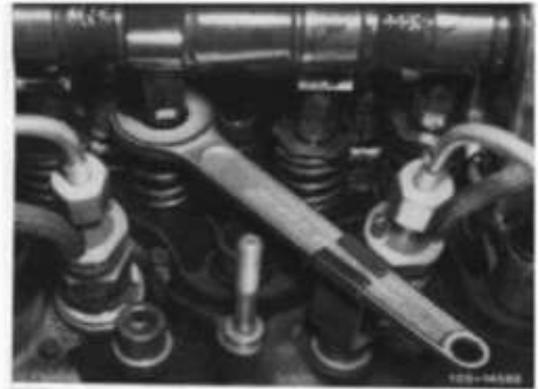
5 Hutmutter (63) mit dem Ventileinstellschlüssel abschrauben.
