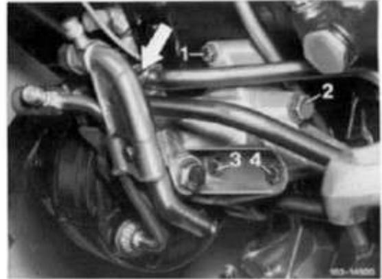
8 Beide Motorstoßdämpfer am Rahmenquerträger bzw. Konsole für unteren Querlenker abschrauben.
