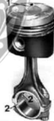
2 Kolbenbolzensicherung entfernen und Kolbenbolzen herausdrücken.
