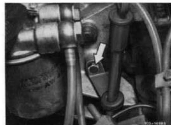
7 Keilriemen des Kältekompressors entspannen und abnehmen.
