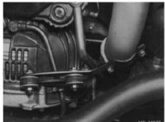
24 Beide Motorstoßdämpfer am Rahmenquerträger bzw. Konsole für unteren Querlenker abschrauben.
