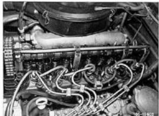
4 Düsenhalter komplett mit dem Steckschlüsseinsatz (27 mm) herausschrauben.
